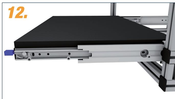
12. Innenschiene mit Schrauben befestigen. Bei Metall-Korpus z.B. mit Zylinderkopfschraube DIN 6912 M5/ M6x10, bei Holz-Korpus z.B. mit Euroschraube 6,3x16 oder Senkschraube 4x16 (nicht im Lieferumfang).
