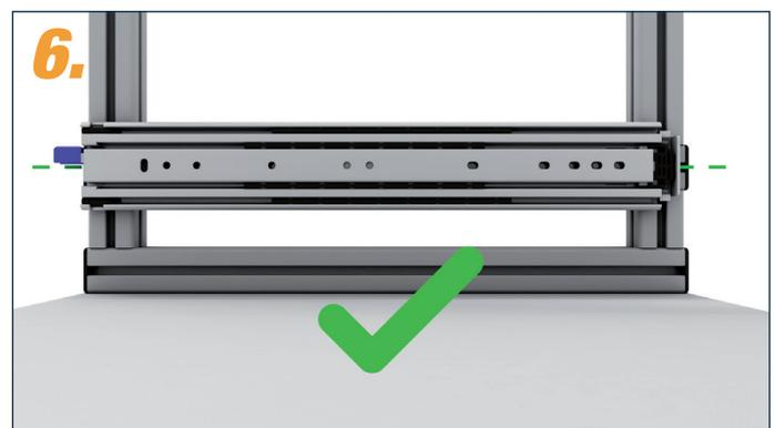
Außenschiene muss parallel zum Boden verlaufen.
