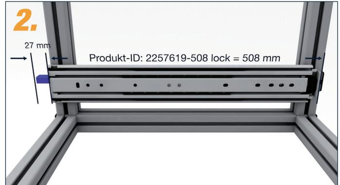
Einbaulänge 508 mm zzgl. 27 mm Entriegelungshebel.
