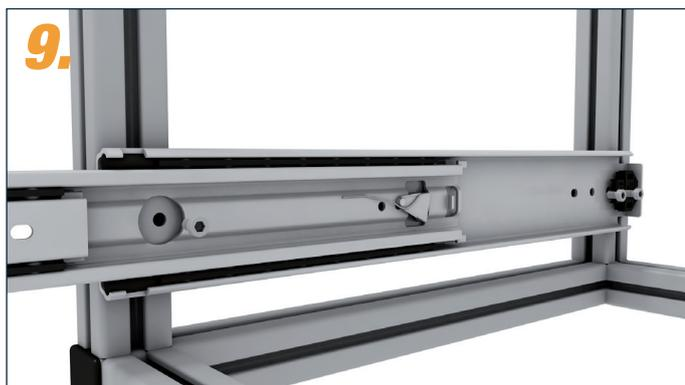
9. Außenschiene mit Schrauben befestigen. Bei Metall-Korpus z.B. mit Zylinderkopfschraube DIN 6912 M5/ M6x10, bei Holz-Korpus z.B. mit Euroschraube 6,3x16 oder Senkschraube 4x16 (nicht im Lieferumfang).
